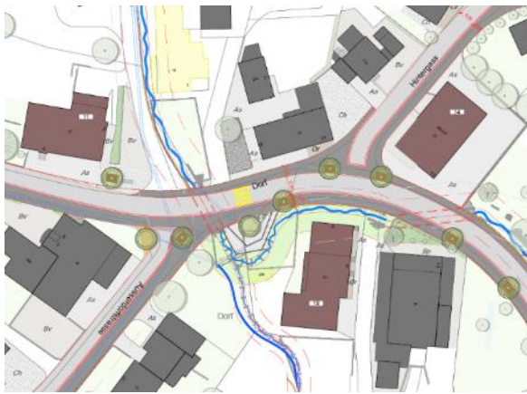
Abbildung 24: Südseitiges Trottoir mit nordseitigem Trottoir im Zentrum
